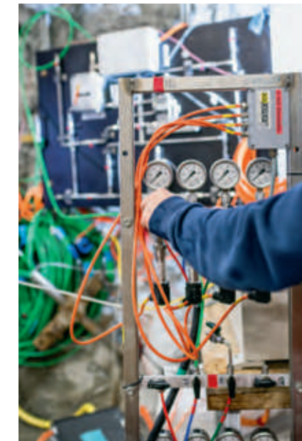
Projektleiter Florian Amann. Mit einem Handgriff reguliert er den Wasserdruck in einem Bohrloch.
