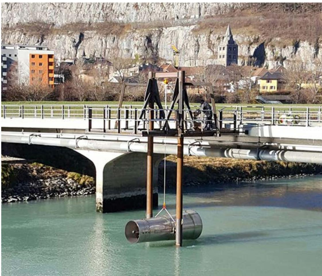
Durant une année, ils ont fait fonctionner une hydrolienne dans le canal de fuite de la centrale de Lavey (VD) et ont analysé à quelle profondeur et à quelle inclinaison la turbine atteignait sa puissance maximale. Les mesures de la puissance ont dépassé de loin leurs attentes : Elle dépassait en moyenne d'un tiers la valeur escomptée.
