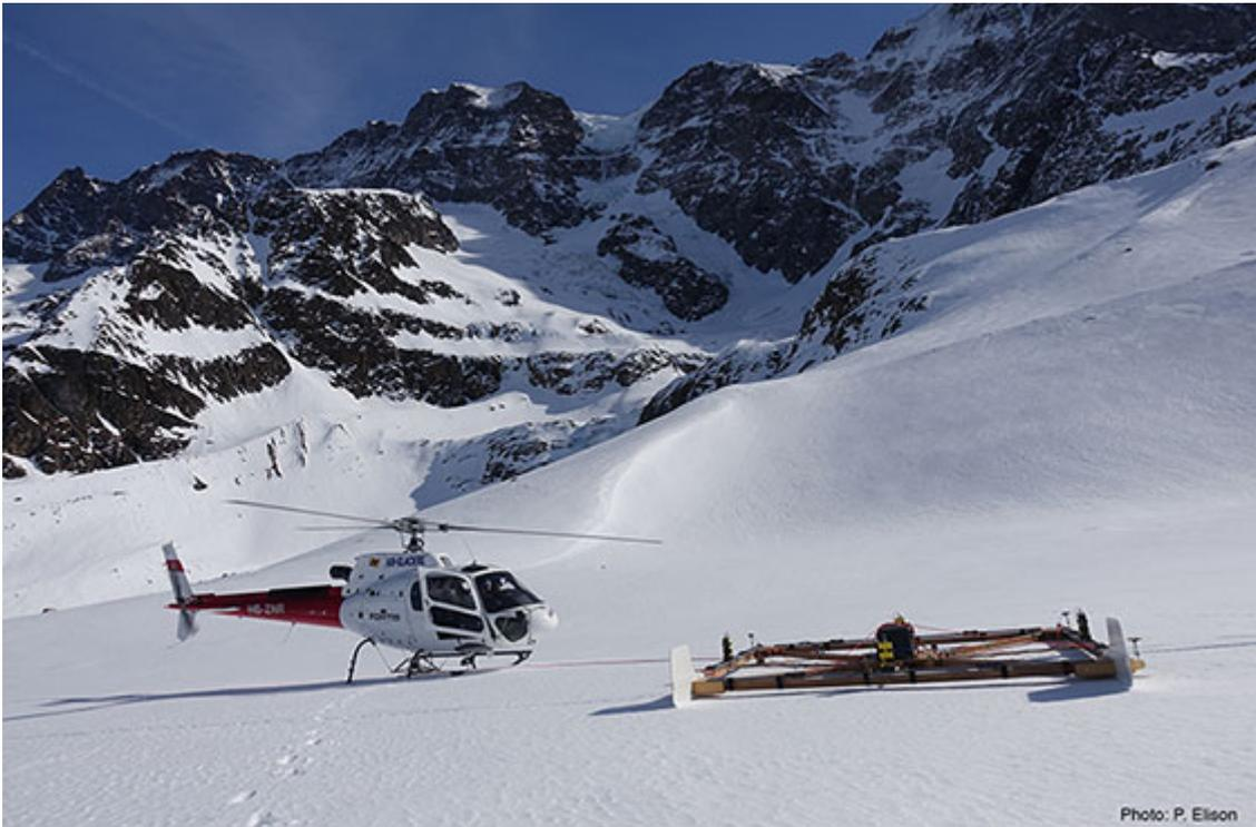
**Fin de la mesure des glaciers suisses à l'aide d'un radar hélicopté**
